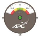
Die dritte Grundregel ist, wenn alle Versuche der Stabilisierung europäisch versagen, wird der Strom bei 51,5 oder 47,5 Herz gezielt heruntergefahren, mit dem wesentlichen Hauptgrund, dass in den Elektrischen Anlagen keine großen Hardwareschäden entstehen. Denn wenn auch dies noch sein sollte, wäre es viel schwieriger das europäische Netz wieder hochzufahren.
